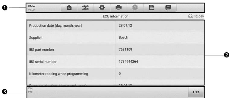
**Рисунок 4-14. Окно, содержащее данные электронного блока управления**
